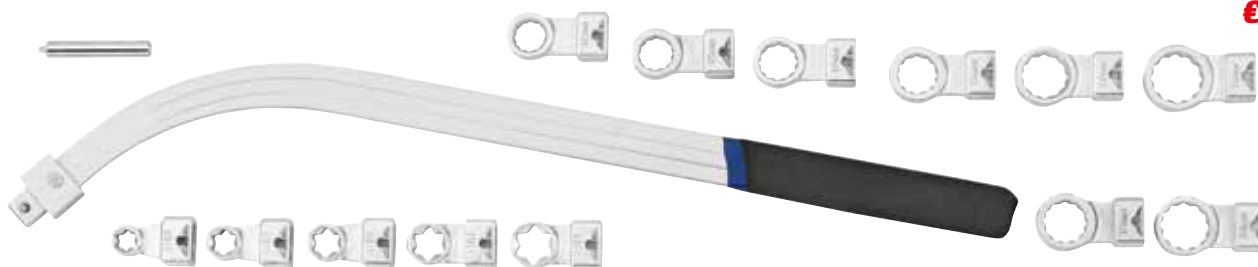
Art. 805015 Set chiavi a stella, 12pt.-19mm, E10-E18, 15 pezzi Testa intercambiabile per la chiave per pulegge. Set di 8 chiavi (bi-esagonali) poligonali e prolunga per l'allentamento dei bulloni usati per la messa in fase, il tenditore e la puleggia ausiliaria. Ideale per la maggior parte delle auto.
