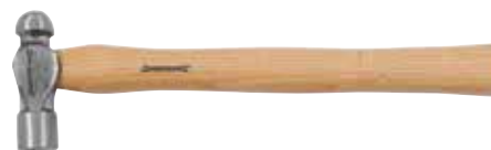
Art. 4822503 Schlosserhammer, englische Form mit Holzgriff Länge 320mm Gewicht 454g
