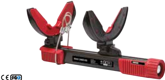
CE Art. 110001 Pressore per molle ammortizzatori 1800 kg - Maniglie adattabili al 90% su tutte le automobili - Fornito con due set di sollevatori: 2-pcs. Ø80-145mm e 2 pcs. Ø145-195mm
